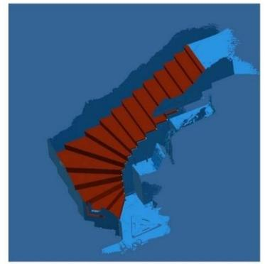
Diese Analyse ermöglicht es uns, die Visualisierung und Erstellung der Produktionsdaten am CAD durchzuführen. In der Planung werden sämtliche technischen Daten erarbeitet, die für die maschinelle Produktion auf der CNC benötigt werden. Durch den Einsatz spezieller Tools haben wir einen nahtlosen Produktionsprozess entwickelt, der es uns ermöglicht, die Produktionsdaten innerhalb kurzer Zeit zu erstellen und an die entsprechenden Arbeitsplätze zu verteilen.
